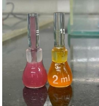
Figura 22. Determinación de la densidad de los extractos.
