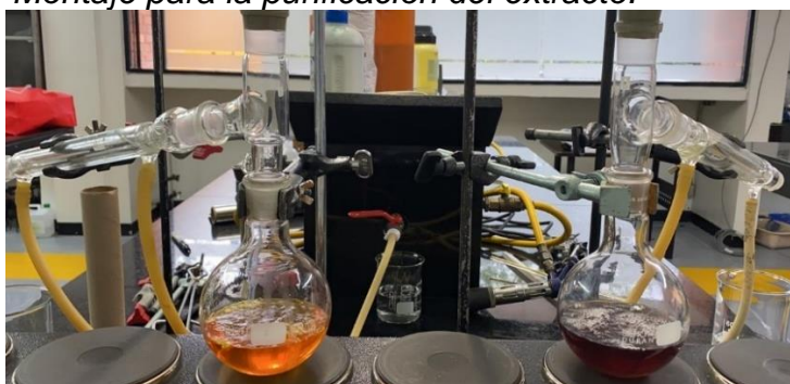
Figura 18. Montaje para la purificación del extracto.
