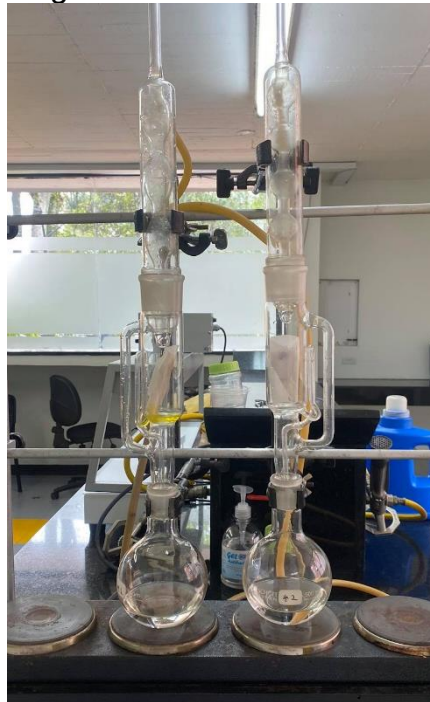
Figura 11. Montaje para la determinación de grasa bruta.
