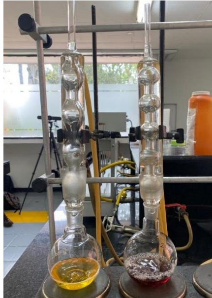
Figura 12. Montaje para la determinación de fibra cruda.
