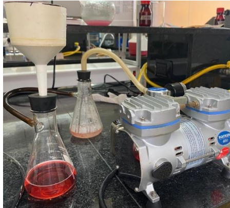
Figura 13. Filtración para la determinación de fibra cruda.
