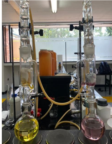
Figura 16. Montaje Soxhlet para la extracción A.
