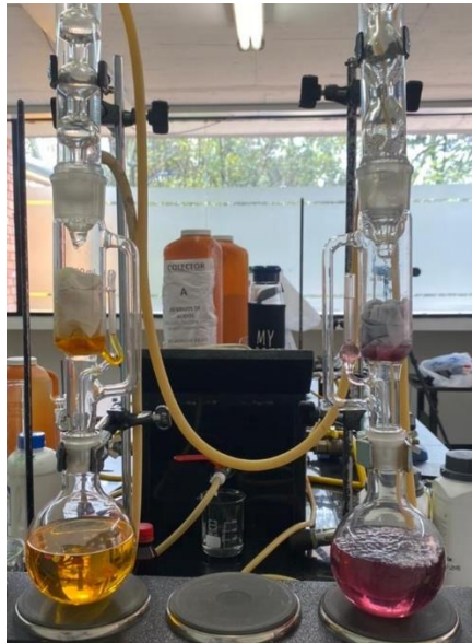
Figura 17. Montaje Soxhlet para la extracción B.
