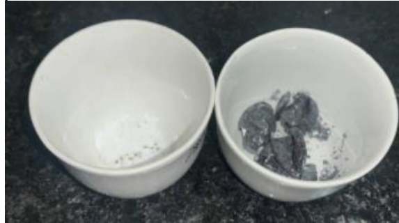
Figura 10. Determinación del contenido de cenizas por incineración.
