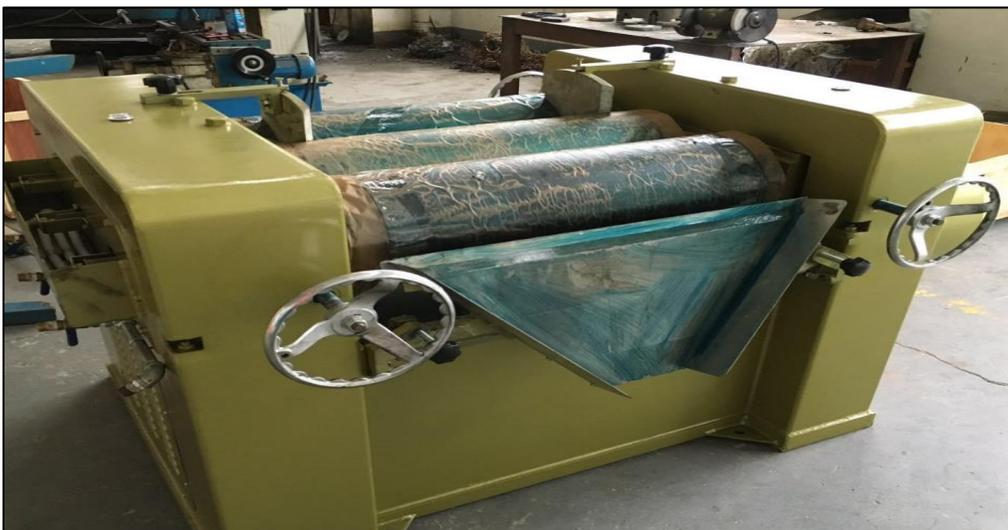
**Nota:** La presente imagen muestra el molino de rodillos modelo TXFM-Ts de la marca Taixing a usar en el pretratamiento físico de la cascarilla de arroz. Tomado de: L. Henan Taixing Grain and Oil Equipment Co., “Mini rodillo molino de harina de trigo planta molino de harina precio.” <https://spanish.alibaba.com/product-detail/lab-industrial-three-roller-> (accessed Mar. 08, 2021).
