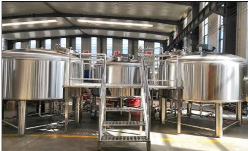
**Nota:** La presente imagen muestra el reactor de marca HG necesario para el proceso de hidrólisis y fermentación simultánea. Tomado de: L. Shandong HG Machinery Co., “Fermentadores de cerveza de 500L y 1000L, Micro fermentador de cerveza, equipo de fabricación para la venta.”
