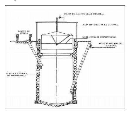
**Nota.** La figura esquematiza el biodigestor modelo hindú. Tomado de E. R. Razo Azhig y M. I. Villafuerte Lopez, «Diseño, construcción y pruebas de un biodigestor experimental para fines didácticos», p. 93, 2007, [En línea]. Disponible en: <a href="https://bibdigital.epn.edu.ec/handle/15000/306">https://bibdigital.epn.edu.ec/handle/15000/306</a>.
