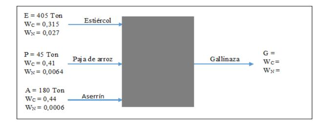
**Nota.** En la figura se puede observar un esquema general del balance de masa donde se define la proporción y la cantidad de cada corriente conocida. Elaboración propia.
