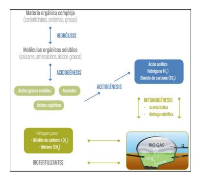
**Nota:** La figura representa las etapas de la digestión anaerobia. Tomado de FAO, "Guía teórico-práctica sobre el biogás y los biodigestores", *Colección Doc. Técnicos*, p. 104, 2019, [En línea]. Disponible en: <a href="http://www.probiomasa.gob.ar/pdf/GuiadeBiogasyBiodigestores-19-07-10.pdf">http://www.probiomasa.gob.ar/pdf/GuiadeBiogasyBiodigestores-19-07-10.pdf</a>
