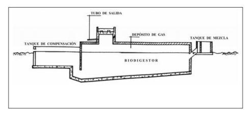
**Nota.** La figura esquematiza el biodigestor modelo hindú. Tomado de E. R. Razo Azhig y M. I. Villafuerte Lopez, «Diseño, construcción y pruebas de un biodigestor experimental para fines didácticos», p. 93, 2007, [En línea]. Disponible en: <a href="https://bibdigital.epn.edu.ec/handle/15000/306">https://bibdigital.epn.edu.ec/handle/15000/306</a>.
