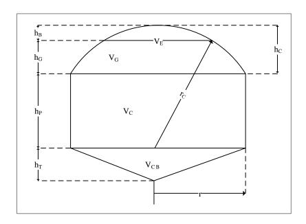
**Nota.** En la figura se esquematiza las partes del tanque de digestión del biodigestor modelo chino. Elaboración propia.
