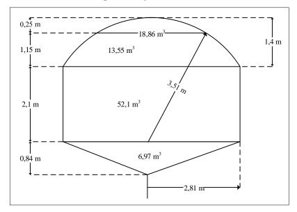
**Nota.** La figura esquematiza las dimensiones del tanque de digestión.
