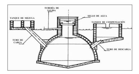
**Nota.** La figura esquematiza el biodigestor modelo hindú. Tomado de E. R. Razo Azhig y M. I. Villafuerte Lopez, «Diseño, construcción y pruebas de un biodigestor experimental para fines didácticos», p. 93, 2007, [En línea]. Disponible en: https://bibdigital.epn.edu.ec/handle/15000/306
