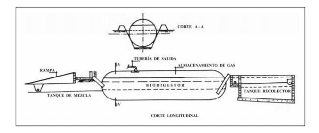
**Nota.** La figura esquematiza el biodigestor modelo tubular. Tomado de E. R. Razo Azhig y M. I. Villafuerte Lopez, «Diseño, construcción y pruebas de un biodigestor experimental para fines didácticos», p. 93, 2007, [En línea]. Disponible en: <a href="https://bibdigital.epn.edu.ec/handle/15000/306">https://bibdigital.epn.edu.ec/handle/15000/306</a>.
