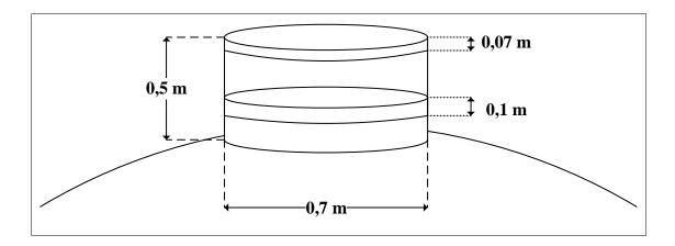
**Nota.** La figura esquematiza las dimensiones del cuello en el tanque de digestión. Elaboración propia.
