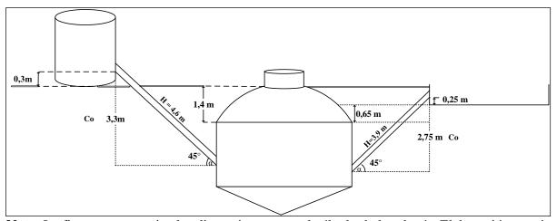
Nota. La figura esquematiza las dimensiones para el cálculo de la tubería. Elaboración propia.
