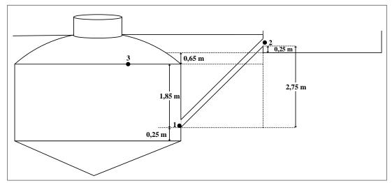
**Nota.** La figura esquematiza las alturas para el cálculo de presiones entre el tanque de digestión y el de compensación. Elaboración propia.
