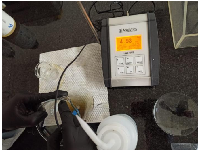
Figura 10. Ensayo pH del carbón activado
