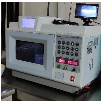
**Nota.** La fotografía muestra la coprecipitación asistida con microondas (MW) de la solución de  $K_2CO_3$ , nitratos y  $NaOH$ .
