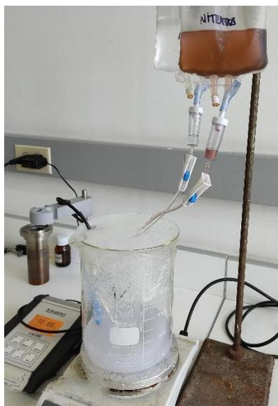
**Nota.** La fotografía muestra la preparación de la solución de carbonato de potasio, nitratos e hidróxido de sodio. En el beaker se encuentra la solución de  $K_2CO_3$ , en la parte superior derecha se encuentra una bolsa con líquido marrón la cual es la que suministra la mezcla de nitratos y atrás de esta se encuentra la bolsa con la solución de  $NaOH$ .
