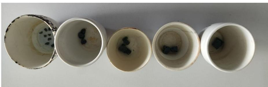
**Nota.** La fotografía muestra los catalizadores implementando el método 1 en forma de pellets obtenidos en el laboratorio.
