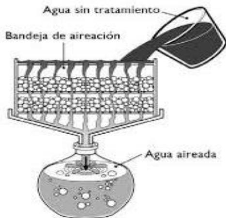
**Nota.** La figura representa el tratamiento del agua sin tratamiento a través de un sistema de aireación para oxigenar el agua y eliminar compuestos indeseados. Tomado de: “Tratamiento de emergencia de agua potable en el lugar de consumo”. Disponible: <http://bvspers.paho.org/share/ETRAS/AyS/texcom/desastres/opsguia5.pdf>.
