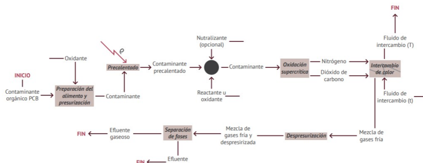
Esquema del proceso de oxidación supercrítica para PCB's
