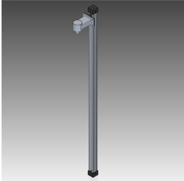
El cilindro A, es un cilindro neumático sin vástago, al cual se encuentra acoplado el motor neumático que se encargara de hacer el agujero mediante la barrena seleccionada.
