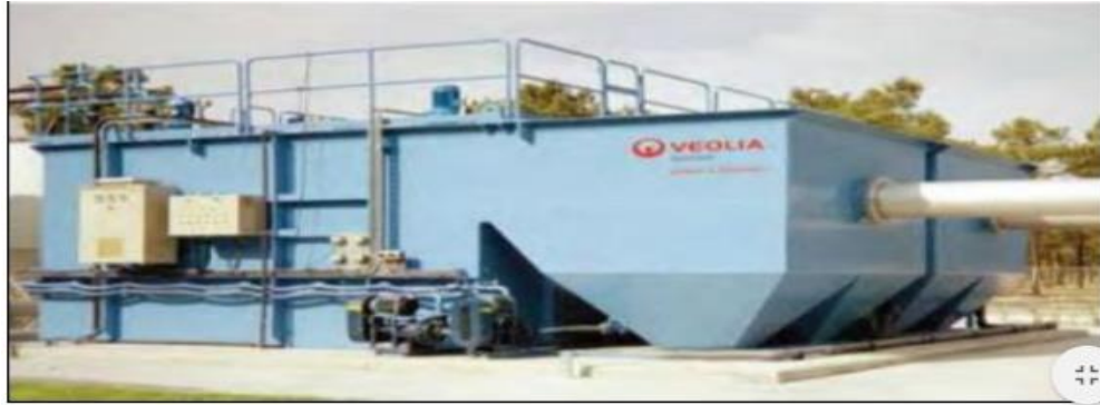
Figura 20. Separador de flotación por aire disuelto.
