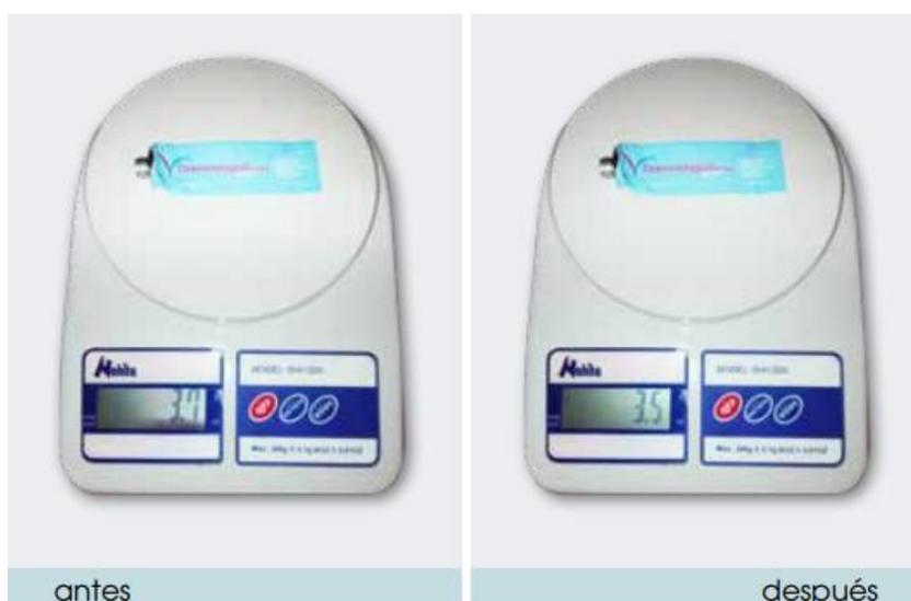
Nota. Peso antes de 3,7 g de tubo colapsible en la imagen izquierda y peso después de la reducción del espesor de 3,5 g. Fuente. V Catálogo de Medidas de Prevención del Sector Farmacéutico (SIGRE Sistema Integrado de gestión y Recogida de Envases del Sector Farmacéutico, 2018)
