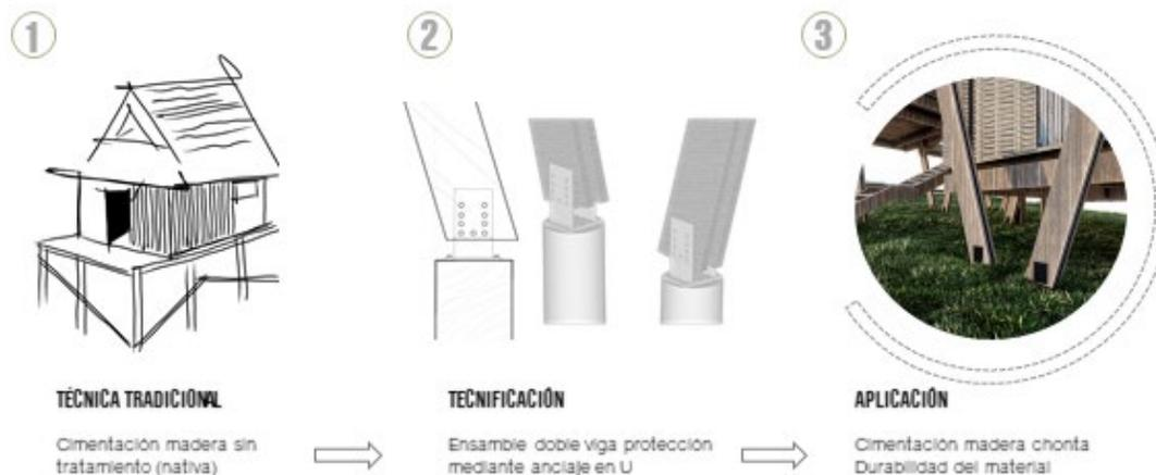
**Nota.** Tecnificación de la técnica tradicional, basada en la aplicación de un sistema de doble viga con anclajes liberados de humedad.
