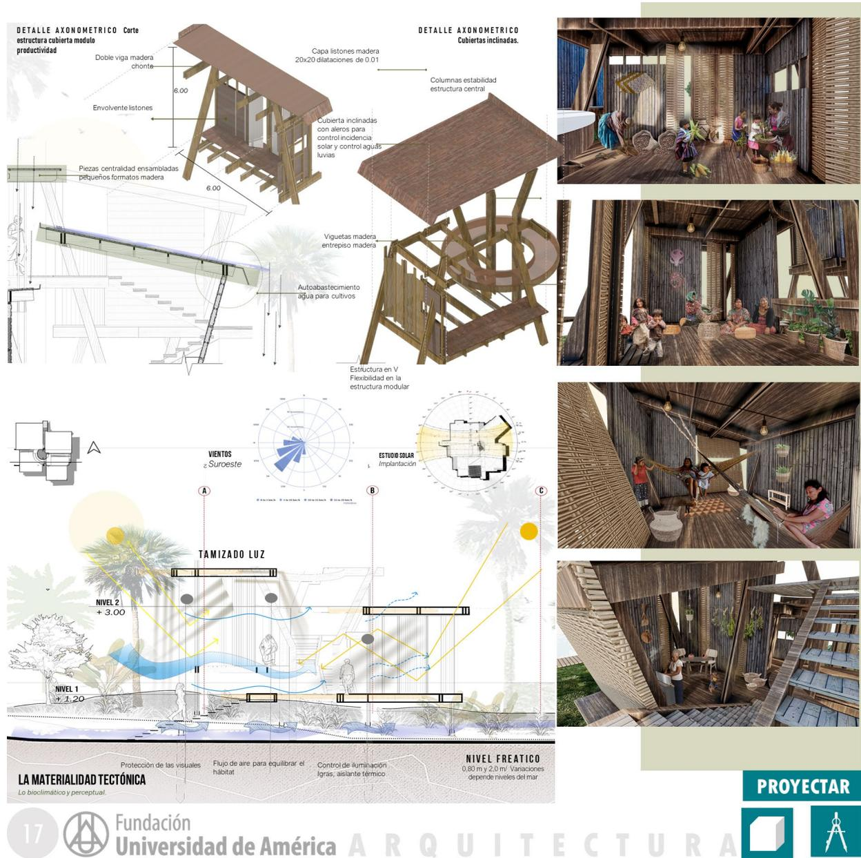
**Nota.** Análisis bioclimático desde la respuesta en cubierta y envolvente.
