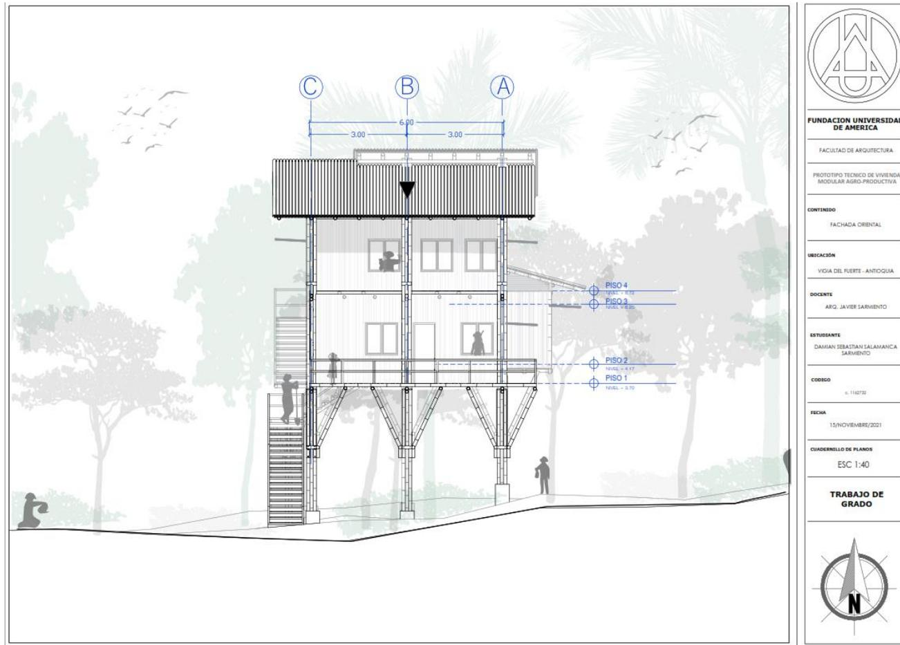
**Nota.** La fachada oriental se observa los puntos fijos y el acceso además del sombrero (cubierta) y los zapatos (zapatas) que son elementos primordiales para aislar la vivienda de las condiciones del lugar.
