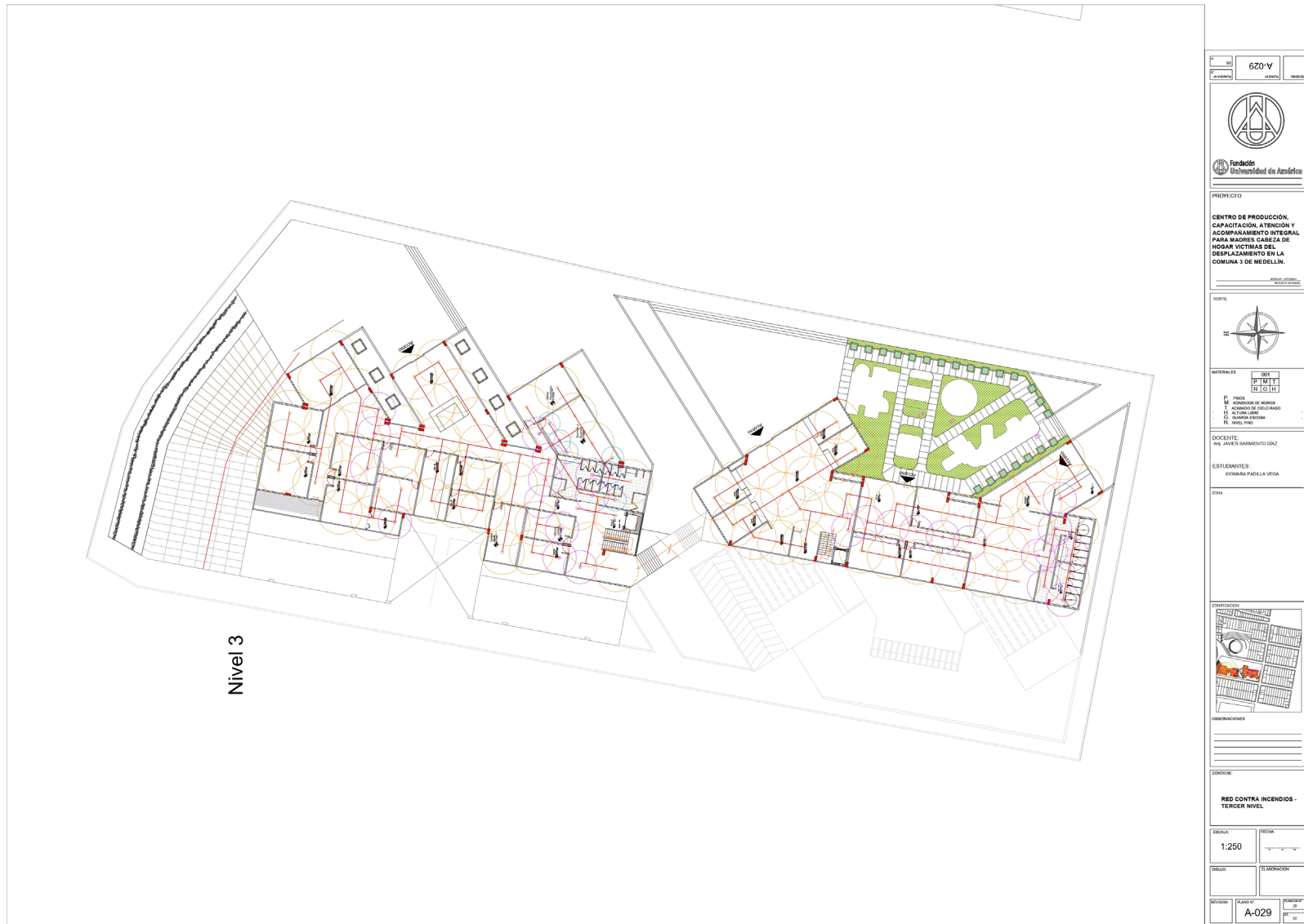
Planta de Red contra Incendios Tercer Nivel.
