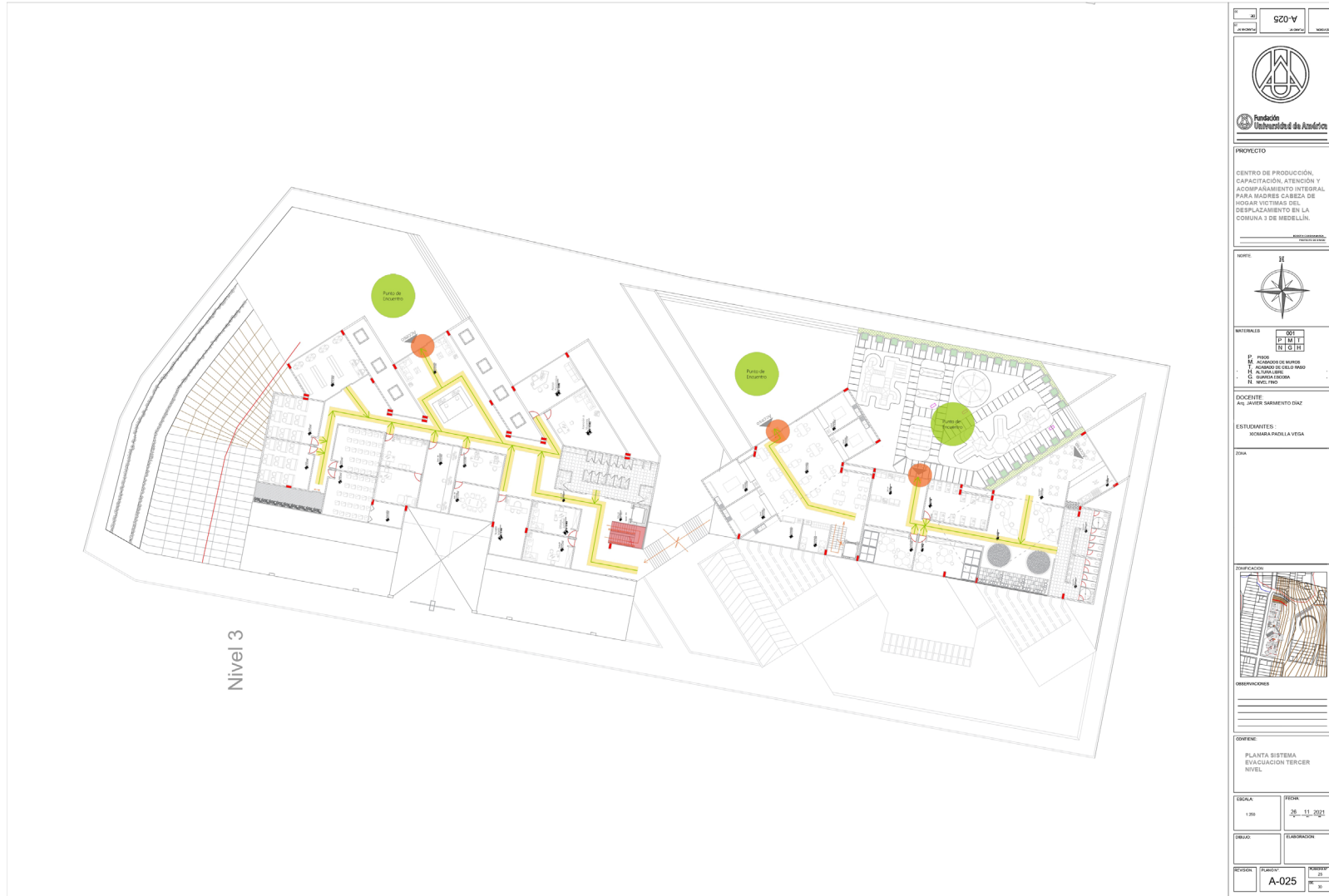
Planta Ruta de Evacuación Tercer Nivel.
