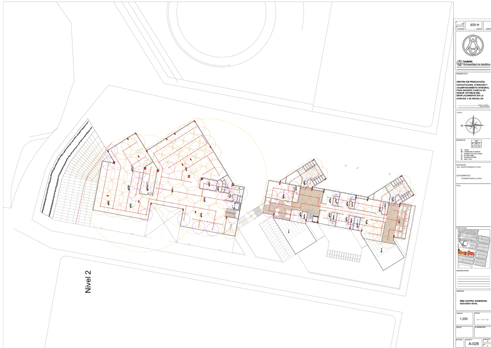
Figura 50. Planta de Red contra Incendios Segundo Nivel.
