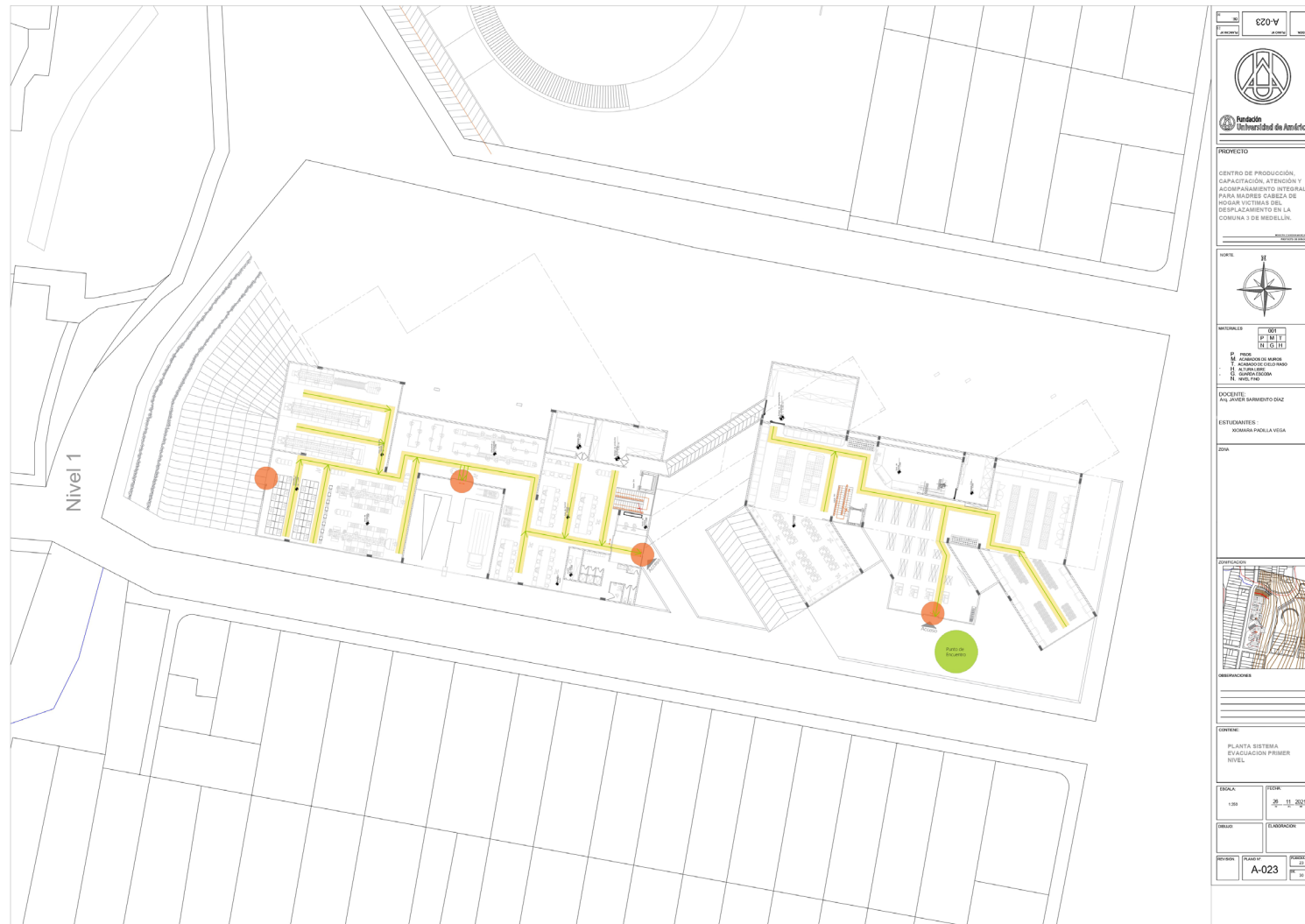
Figura 45. Planta Ruta de Evacuación Primer Nivel.
