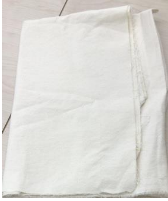
Nota. La Figura 25 muestra la tela tipo lona usada en la deshidratación de residuos.
