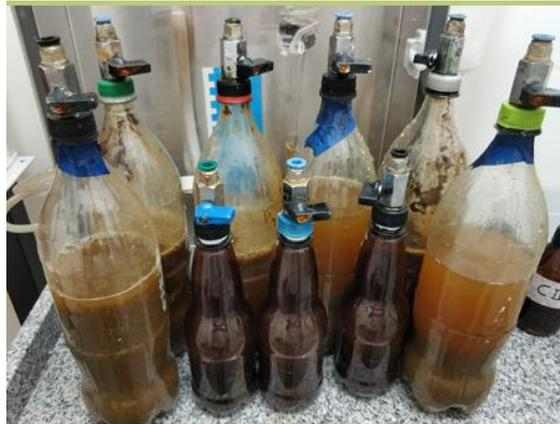
**Nota.** Biodigestores Batch escala laboratorio. Tomado de Catedra de Química Analítica-FAURA [Acceso: Nov.13,2021]
