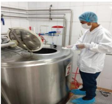
*Nota.* Proceso de muestreo en la marmita donde se concentra la fruta para ser mezclada en el proceso de fabricación del helado. Tomado de la empresa ODA GELATO.
