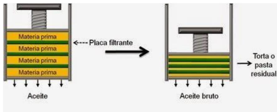
**Nota:** Se puede evidenciar el funcionamiento del método de extracción por prensado.
