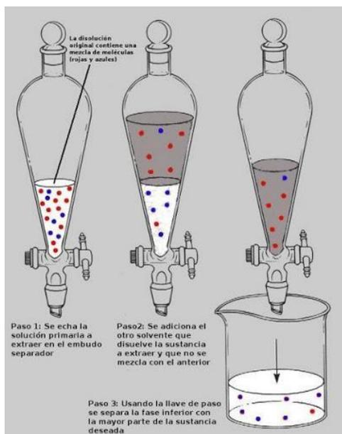
**Nota.** Se puede evidenciar el funcionamiento del método de extracción por solventes volátiles.
