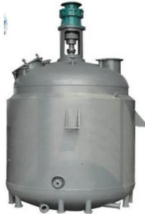
**Nota.** Equipo de extracción por solvente (ETANOL). Fuente: <https://www.tradewheel.com/p/50001-jacketed-heating-chemical-industrial-batch-476945/>
