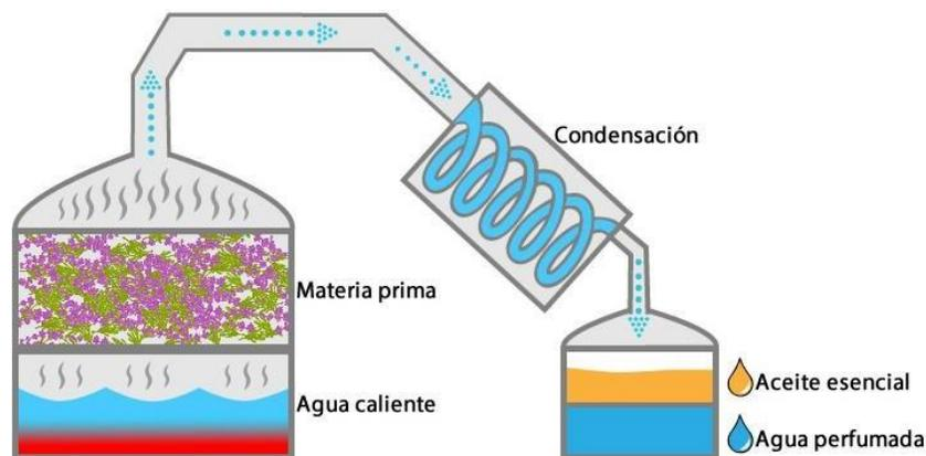
**Nota.** En la figura se evidencia en proceso de obtención de aceite por medio de arrastre de vapor. Tomado de: <https://www.perfume-man.com/destilacion-arrastre-vapor/>
