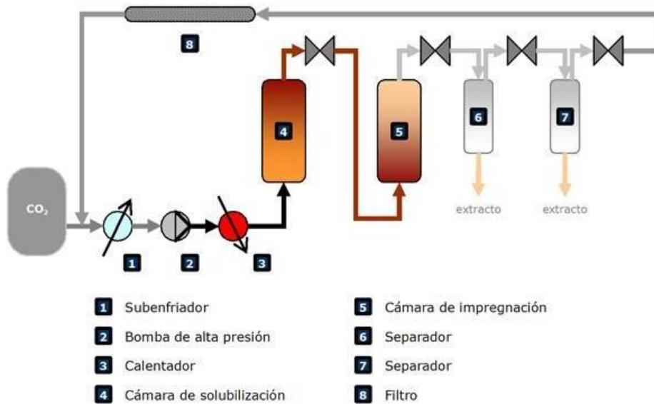
*Nota.* Se observa el proceso de extracción por fluidos supercríticos para obtención de aceite. Tomada de: <https://www.interempresas.net/Textil/Articulos/98999-Aplicaciones-de-la-tecnologia-de-fluidos-supercriticos-en-el-sector-textil.html>
