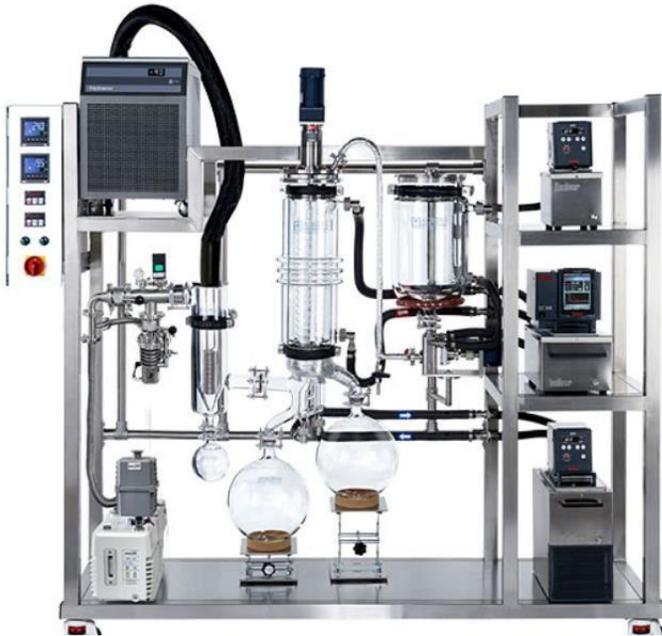
*Nota.* Equipo de extracción por solvente (ETANOL). Tomado de: PRECISIÓN EXTRACTION.
