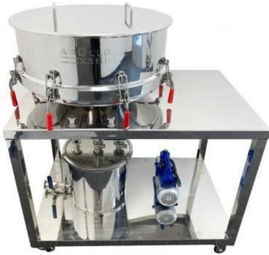
**Nota.** Equipo de extracción por solvente (ETANOL).
