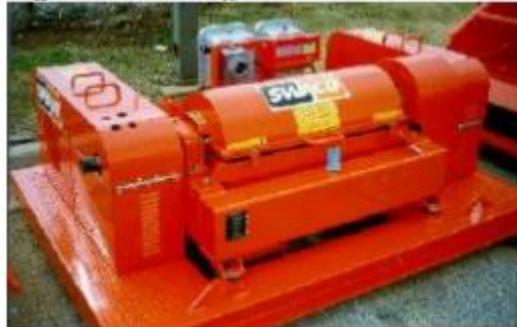
**Nota.** Se muestra los componentes de una centrifuga decantadora utilizada en el proceso de remoción de sólidos. Tomado de: SWACO. Escuela básica de fluidos de perforación. Control de sólidos. s.f. p. 95. <https://repository.uamerica.edu.co/bitstream/20.500.11839/633/1/5131638-2016-2-GA.pdf>
