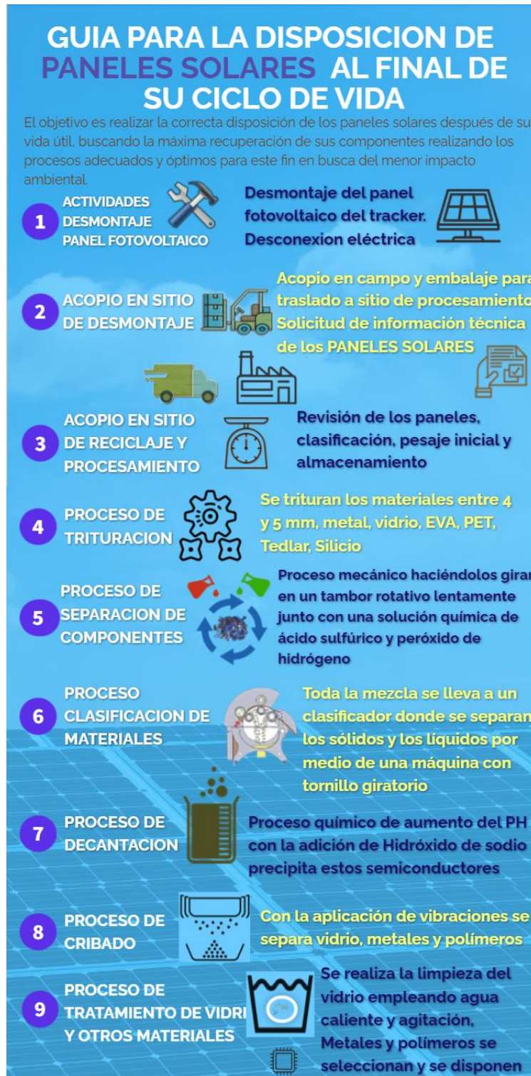
Guía gráfica del proceso mecánico de reciclaje paneles solares
