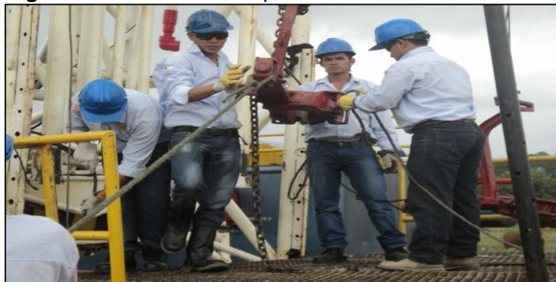
Figura 93. Procedimiento para levantamiento de cuña.
