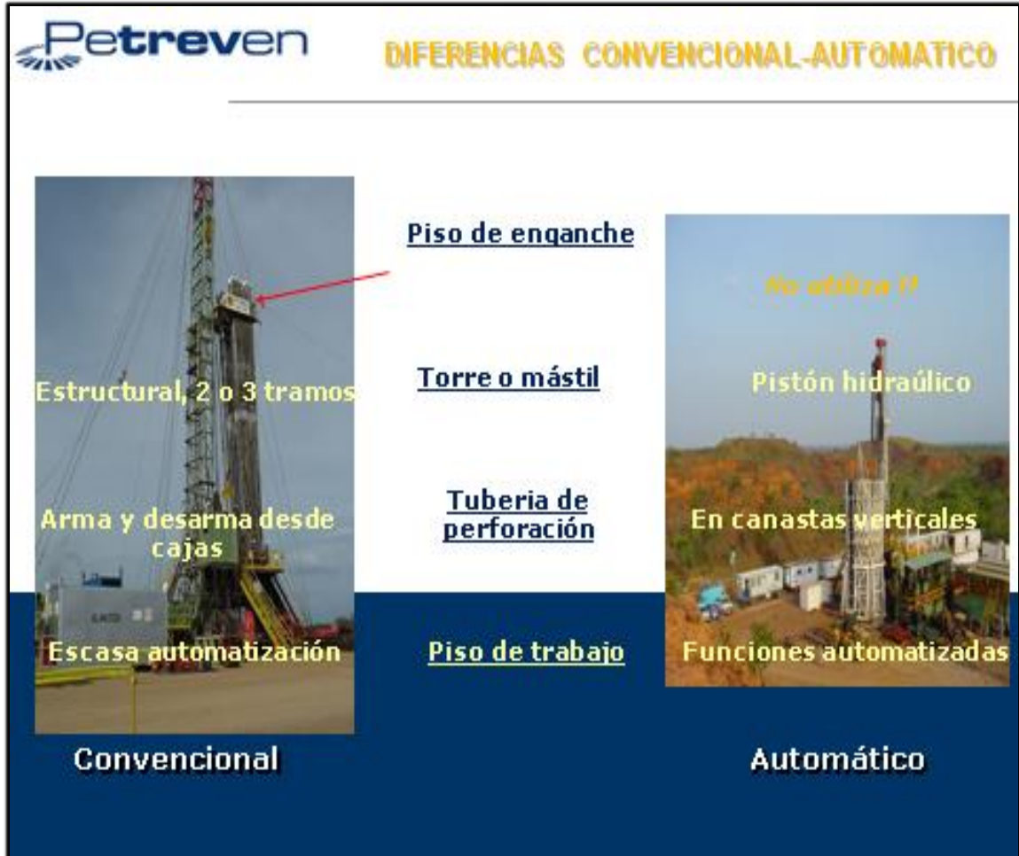
Figura 13. Diferencias principales entre equipos convencionales y automáticos
