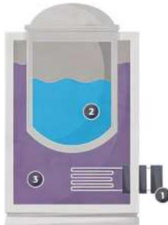
*Nota.* Sistema de calentamiento indirecto. Tomado de: Pirobloc. (2021), “Sistemas de fluido térmico:Guia completa”, [En línea].<https://www.pirobloc.com/sistemas-de-fluido-termico-la-guia-completa/> [Acceso: Octubre 13, 2021]
