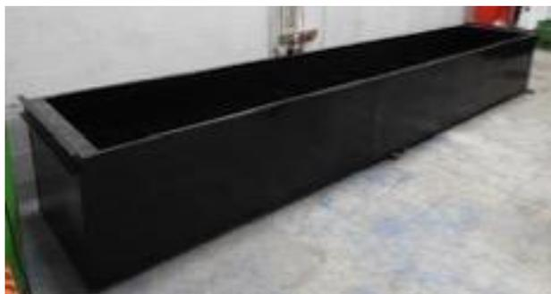
*Nota.* La figura representa el tanque para el proceso de enfriamiento del material que sale de la extrusora
