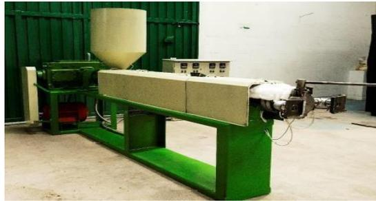
*Nota.* Maquina utilizada para la fabricación de madera plástica
