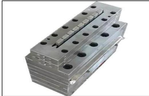
*Nota.* La figura representa el molde utilizado para la obtención de madera plástica
