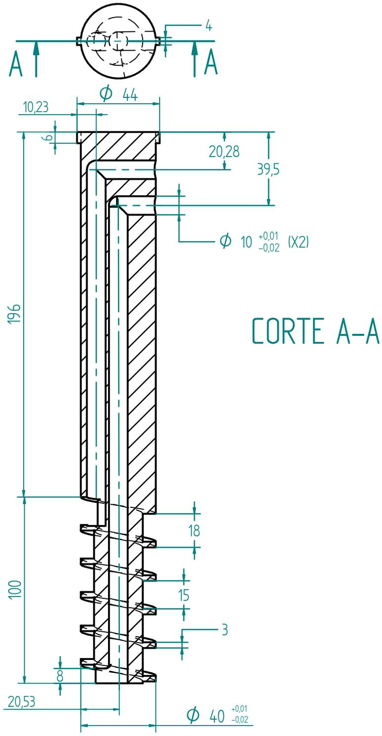
Se selecciona el espiral utilizando el catálogo. La figura representa el esquema general del espiral de refrigeración Hasco. Tomado de: "Sistema de temperado", Hasco.com. [En línea]. Disponible en: <https://www.hasco.com/es/Cat%C3%A1logo-de-productos/Z/Sistema-de-temperado/c/PIM0308?search=true>. [Accedido: 24-may-2022]
