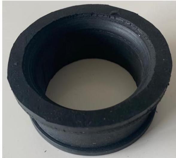
**Nota.** Buje de caucho escogida como rueda de fricción para el sistema de generación energética
