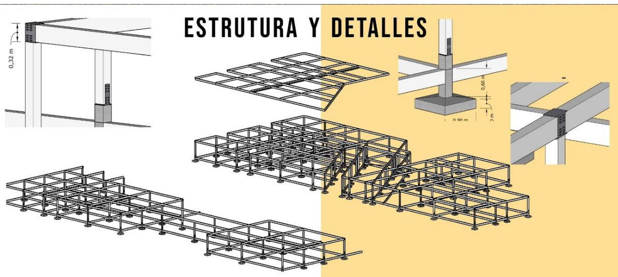
**Nota** se puede ver que el sistema constructivo predominante es el de pórticos con una cimentación media en zapatas y sistema de armazón metálico
