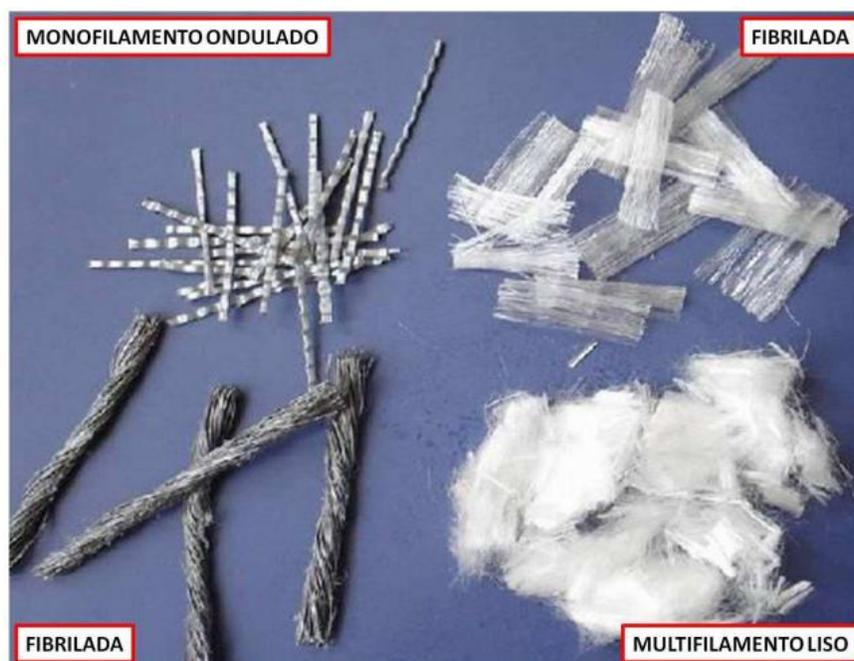
*Nota.* Clasificación de fibras de polipropileno utilizadas en el concreto. Disponible en: «PSI Concreto, Fibra de polipropileno para concreto,» [En línea]. Available: <https://psiconcreto.com/fibra-de-polipropileno/>. [Último acceso: 20 octubre 2021]
