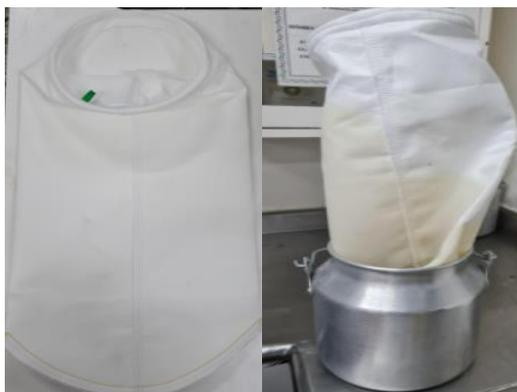
**Nota.** En la figura se puede evidenciar el uso del filtro gaff para el proceso de separación de la enzima y el aceite.
