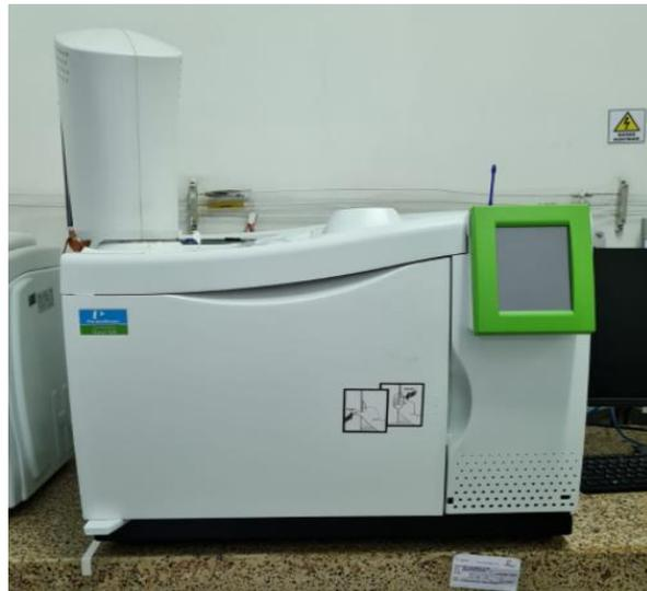
**Nota.** La presente figura muestra el cromatógrafo de gases utilizado para determinar el perfil de ácidos grasos
