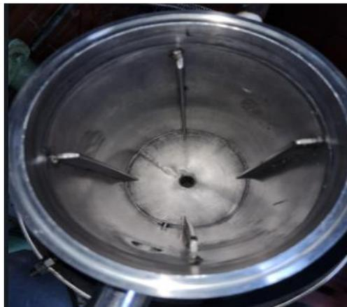
*Nota.* Interior del reactor de la planta piloto de SIGRA S.A el cual posee cuatro baffles.
