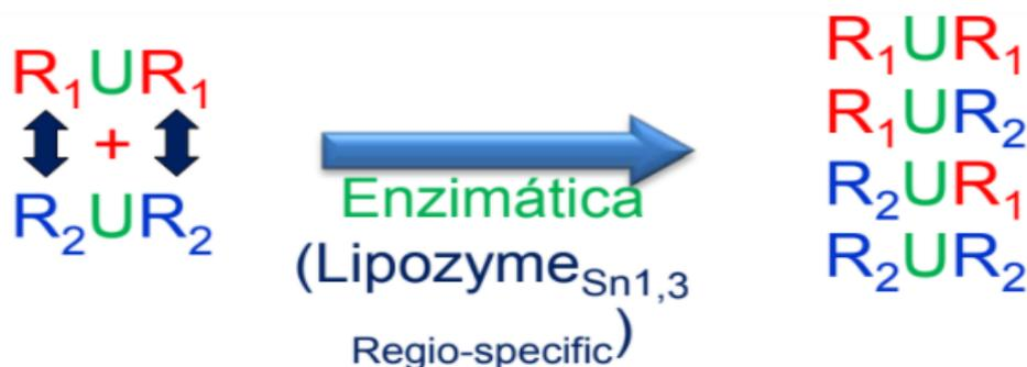
*Nota.* En la presente figura se muestra el mecanismo de reacción selectivo en las posiciones 1 y 3 del triglicérido en la interesterificación enzimática Tomado de: Ghion Serge, Tecnologías de Interesterificación Química y Enzimática, p.p. 16, (2018).
