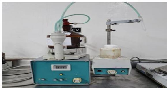
**Nota.** Se muestra el titulador usado para la determinación de la acidez el cual contiene el reactivo NaOH e indica el volumen del mismo en cada titulación
