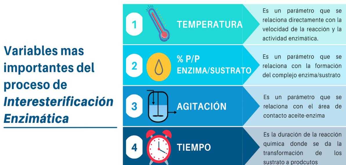
*Nota.* En la figura se presentan las variables del proceso y su importancia dentro del proceso de interesterificación enzimática, las cuales son temperatura, %p/p enzima/sustrato, agitación y tiempo.
