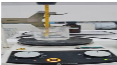
**Nota.** En la figura se muestra el montaje en donde se coloca el beaker sobre una plancha de calentamiento con un agitador magnético.
