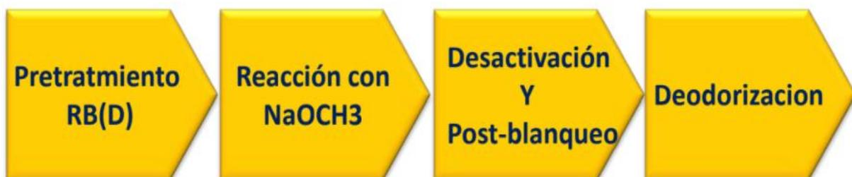
*Nota.* En la presente figura se muestra el diagrama de bloques para llevar a cabo el proceso de interesterificación química. Tomado de: Ghion Serge, Tecnologías de Interesterificación Química y Enzimática, p.p. 22, (2018).
