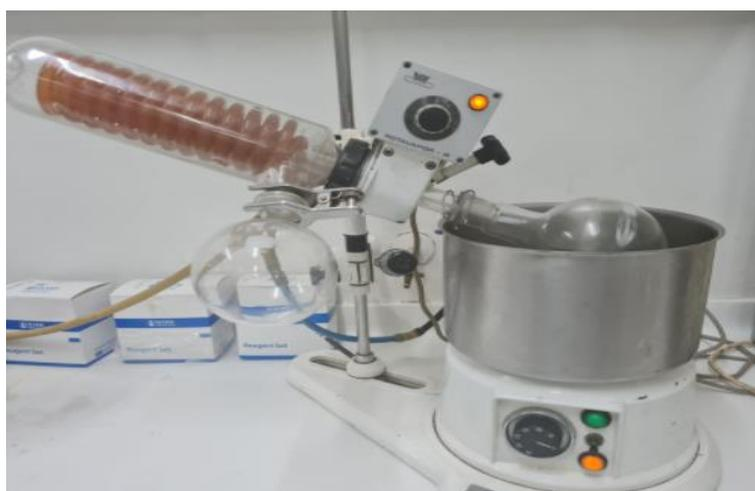
*Nota.* En la presente figura se muestra el montaje de destilación para la recuperación de acetona compuesto por un condensador, un recipiente con calentamiento, dos balones y un rotavapor.
