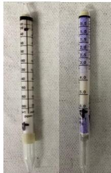
**Nota.** Se presenta una imagen representativa de los tubos dragger y la medición de H<sub>2</sub>S y CO<sub>2</sub>, donde el H<sub>2</sub>S es el tubo de color café y el CO<sub>2</sub> de color azul.
