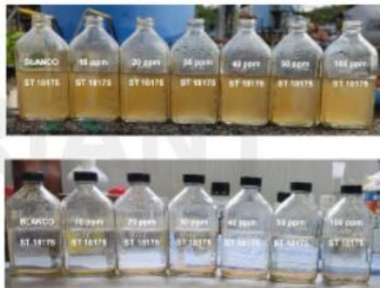
**Nota.** En la figura se observan las diferentes muestras tomadas en cada punto del proceso con el Inhibidor de Scale.
