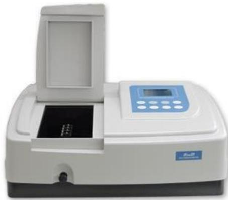
**Nota.** En la figura se muestra un espectrofotómetro para medición de hierros. Tomado de “EULABOR S.L. Espectrofotómetro visible”, [En línea]. Disponible: <https://www.eulabor-tienda.com/espectrofotometro-uv-visible-mod-4201-50-c2x27500302> [Acceso: mar.29,2022].
