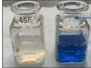
**Nota.** En esta imagen se evidencia el residual de IS después del lavado de la muestra.
