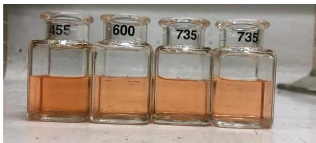
**Nota.** En la figura se observa el color que se genera al disolver la muestra con el ferrover para el análisis de hierros en el espectrofotómetro.
