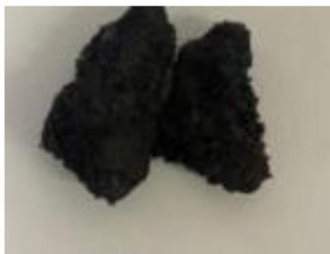
**Nota.** En esta imagen se evidencia la muestra inicial de sólido recolectado en la línea de recirculación del pozo PÑÑ 5.
