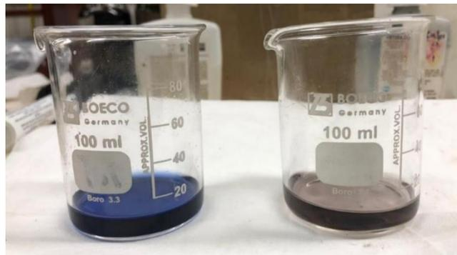
**Nota.** Esta figura se toma de referencia para identificar el color al que debe cambiar la muestra después de titularla, dureza total (muestra azul) y cálcica (muestra gris).
