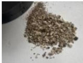
**Nota.** En esta imagen se evidencia la muestra de sólidos ferromagnéticos encontrados en la línea de recirculación del pozo PÑÑ 5.
