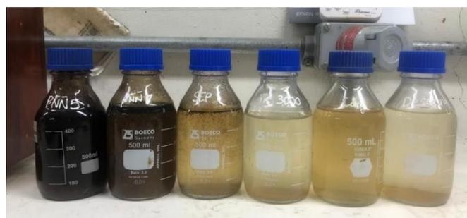
**Nota:** En la figura se evidencia el perfil de calidad de agua del Campo Quillacinga con el Inhibidor de Scale.
