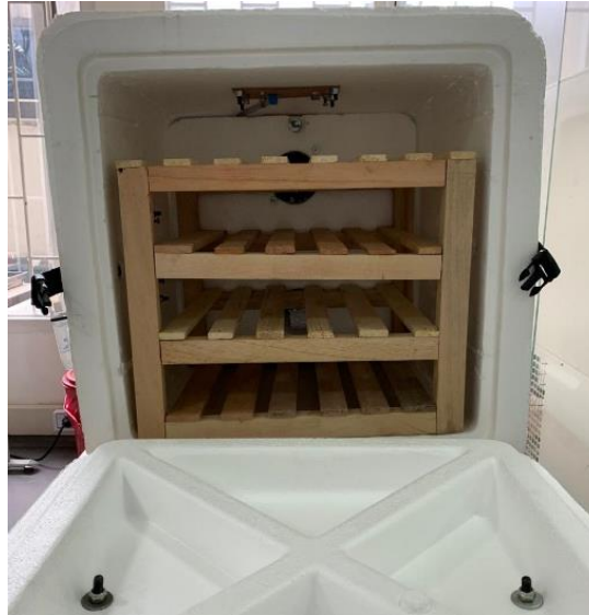
Recámara de biodegradación del reactor
