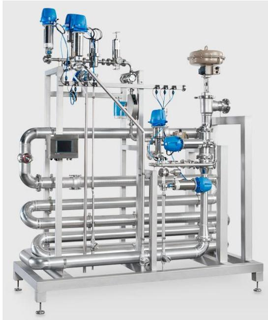
*Nota.* La figura presenta un equipo para carbonatación industrial. Tomado de: GEA, “Sistemas de Carbonatación para Aplicación de Bebidas: sistemas de carbonatación DICAR”. Acceso: Jun. 12, 2022. [En Línea]. Disponible: <https://cutt.ly/MJ2c8Yx>
