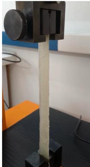
*Nota.* Bioplástico antes de ser sometido a ensayo mecánico.
