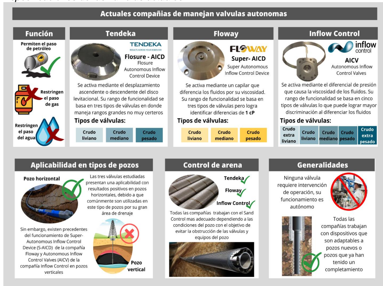
Figura 41. Especificaciones de las válvulas actuales.
