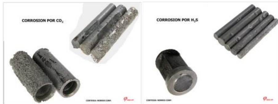
Figura 10. Fallas por Corrosión.
