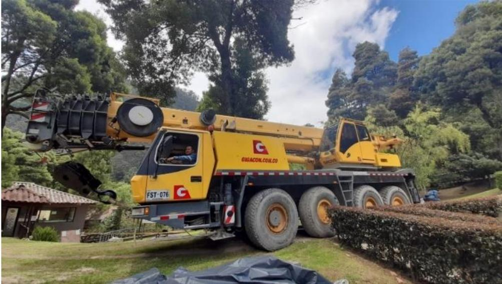
**Nota:** Se aprecia en la Figura 13 la grúa tipo cangrejo empleada para el izaje de los equipos al edificio del CEPIIS.
