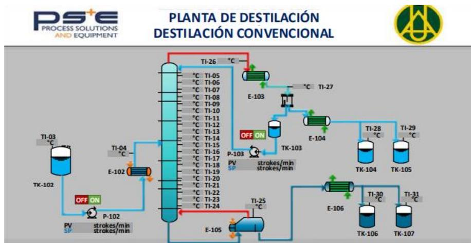
**Nota:** Se evidencia en la figura 5 el esquema de la destilación convencional al momento de realizar la selección de configuración de trabajo en la pantalla principal del sistema de operación de la torre de destilación. Tomado de Process Solutions and Equipment, “Manual de Operación. Planta de Destilación Continua,” p. 57, 2018. Sin publicar. [11]
