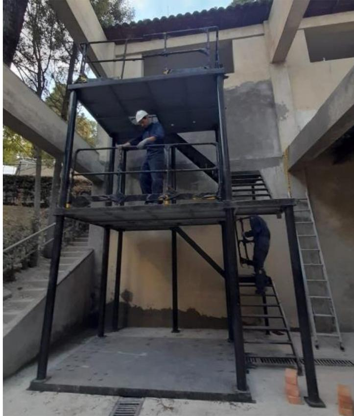
**Nota:** Se evidencia en la Figura 16 la estructura armada y ensamblada de la unidad de destilación continua dentro del edificio del CEPIIS.
