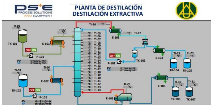
**Nota:** Se evidencia en la figura 4 el esquema de la destilación extractiva al momento de realizar la selección de configuración de trabajo en la pantalla principal del sistema de operación de la torre de destilación. Tomado de Process Solutions and Equipment, “Manual de Operación. Planta de Destilación Continua,” p. 57, 2018. Sin publicar. [11]
