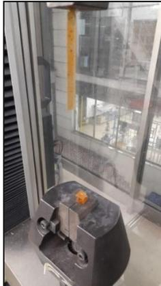
**Nota.** La figura muestra el ensayo de tensión de una de las probetas que presentó fallos en su estructura durante la aplicación de este.
