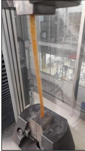
**Nota.** En la figura se puede identificar la probeta de la biopelícula durante el ensayo de resistencia a tracción y elongación.
