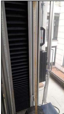
**Nota.** La figura muestra el alto grado de resistencia a tracción y elongación que presentaron algunas probetas.
