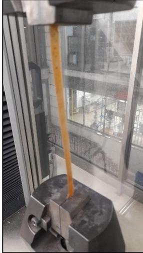
**Nota.** En la figura se puede identificar la probeta de la biopelícula durante el ensayo de resistencia a tracción y elongación.
