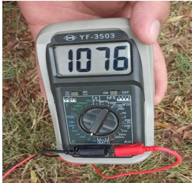
**Nota.** Permite medir conductividades eléctricas del agua en función de la transmisión de iones a través de los cables receptores.
