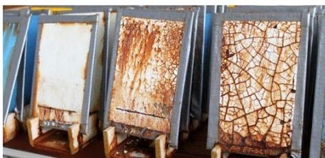
**Nota.** En la Figura se muestra resultados de algunos materiales expuestos a la atmósfera urbana. Tomado de: I. D. C. Y. PROTECCIÓN, «INSTITUTO DE CORROSIÓN Y PROTECCIÓN,» INSTITUTO DE CORROSIÓN Y PROTECCIÓN, 2013. [En línea]. Available: <https://icp.pucp.edu.pe/areas-de-trabajo/ensayos-especiales-de-corrosion/>. [Último acceso: 10 02 2023].
