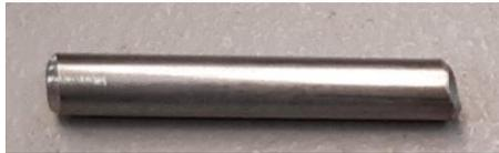
**Nota.** En la figura se muestra el Blanco de prueba del Acero INOX 304.
