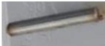
**Nota.** En la figura se muestra el Acero INOX 304 después de estar expuesto cuatro semanas al Dióxido de Cloro.
