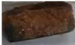
**Nota.** En la figura se muestra el Acero al carbono después de estar expuesto cuatro semanas al Dióxido de Cloro.
