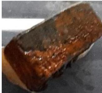
**Nota.** En la figura se muestra el Acero al carbono después de estar expuesto una semana al Dióxido de Cloro.
