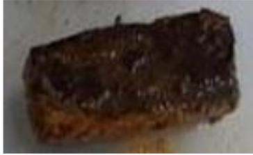
**Nota.** En la figura se muestra el Acero al carbono después de estar expuesto dos semanas al Dióxido de Cloro.
