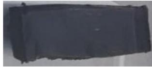
**Nota.** En la figura se muestra del PVC SCH 80 después de estar expuesto una semana al Dióxido de Cloro.
