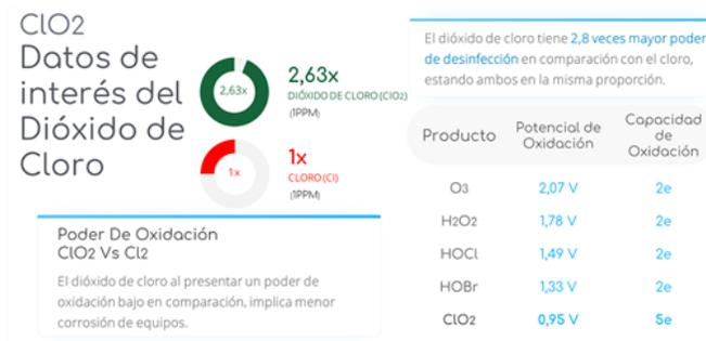
**Nota.** En la figura se muestra las diferencias entre el potencial de oxidación del Dióxido de Cloro con los demás desinfectantes. Tomado de: «Conceptos,» 2022. [En línea]. Available: <https://deconceptos.com/general/compatible>. [Último acceso: 17 Mayo 2022].
