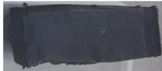
**Nota.** En la figura se muestra del PVC SCH 80 después de estar expuesto cuatro semanas al Dióxido de Cloro.
