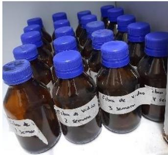
**Nota.** En la figura se muestra los envases ámbar utilizados para las respectivas pruebas de inmersión de cada una de las probetas de los materiales propuestos para el presente proyecto.
