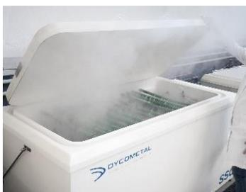
**Nota.** En la figura se muestra una cámara salina para las pruebas de niebla salina. Tomado de: M. Comas, «PROQUIMIA,» PROQUIMIA, 27 03 2018. [En línea]. Available: <https://www.proquimia.com/ensayos-climaticos-de-corrosion-en-superficies-pintadas/>. [Último acceso: 10 02 2023].
