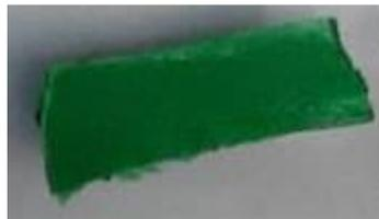
**Nota.** En la figura se muestra de Fibra de vidrio después de estar expuesto dos semanas al Dióxido de Cloro.
