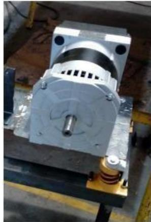
*Nota.* En la figura se puede observar el generador de corriente eléctrica. Obtenido de E. Hernández. “Planta térmica didáctica”. Ingenium ingeniería y consultoría LTDA.
