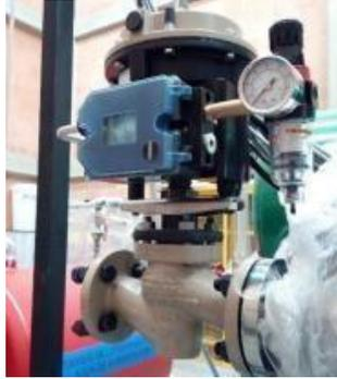
*Nota.* En la figura se puede observar la válvula PID. Obtenido de E. Hernández. “Planta térmica didáctica”. Ingenium ingeniería y consultoría LTDA.
