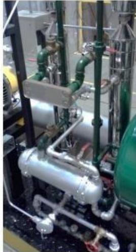
**Nota:** En la figura se puede observar los tanques de agua. Obtenido de E. Hernández. “*Planta térmica didáctica*”. Ingenium ingeniería y consultoría LTDA.
