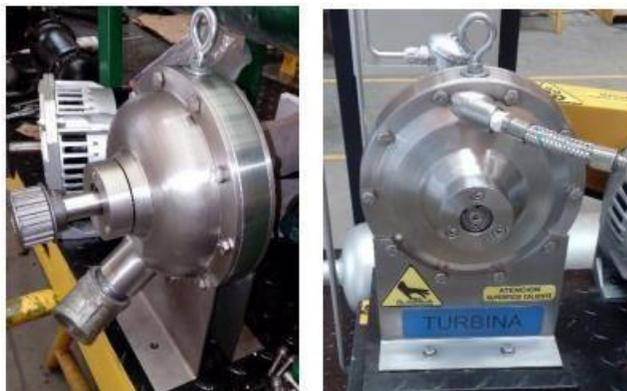
**Nota:** En la figura se puede observar *la turbina de vapor*. Obtenido de E. Hernández. “*Planta térmica didáctica*”. Ingenium ingeniería y consultoría LTDA.
