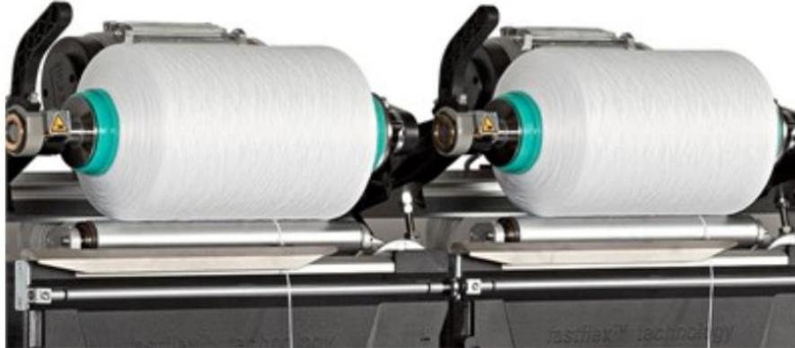
**Nota.** La figura representa el proceso de bobinado que tiene la fibra textil posterior a su extrusión. Fuente: Intorsa,” *Intorsa.es*, 2021.Sollutia.com, “¿Que es el bobinado textil y como lo hacemos? <https://www.intorsa.es/es/noticias/6/que-es-el-bobinado-textil-y-como-lo-hacemos-en-intorsa.html> (accessed Oct. 22, 2022)
