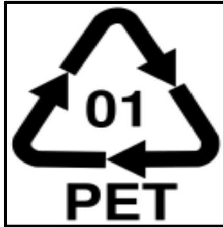
**Nota.** La figura representa la identificación del PET representada por el número uno encerrado por del triángulo de Mobius. Tomado de seguridad ChemicalSafetyFacts. Tipos de envases de plástico para alimentos. Disponible en: <https://www.chemicalsafetyfacts.org/es/tipos-de-envases-de-plastico-para-alimentos-y-seguridad-una-mirada-de-cerca/>
