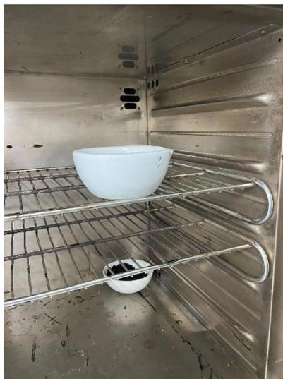
**Nota.** En la imagen se puede observar el proceso de secado del textil para retirarle la humedad y seguir con la prueba.
