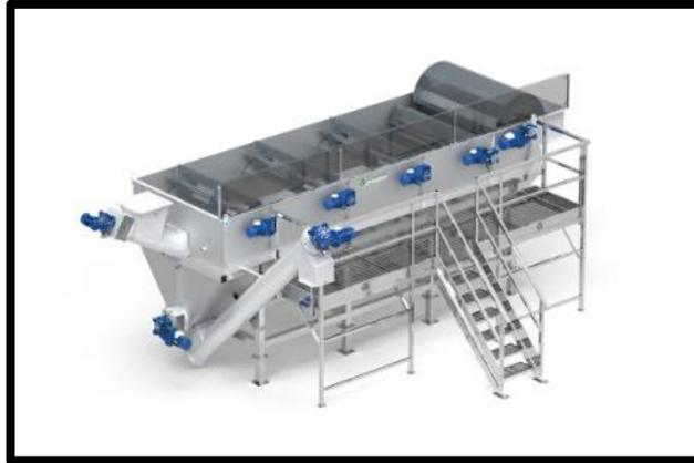
**Nota.** La figura representa una tina de lavado la cual se requiere para el proceso. Fuente: Tecnofer,” *Tecnofer*. “Tina de Lavado para Plástico.
