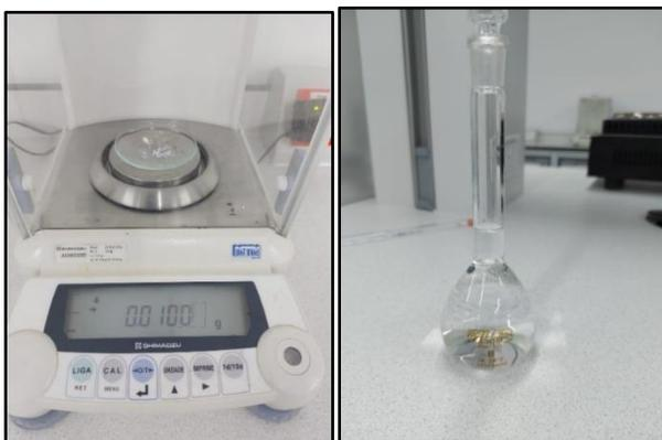
**Nota.** La figura muestra la cantidad de ácido gálico que se pesó para poder crear la solución stock, luego de llenar el volumen del matraz hasta el aforo.
