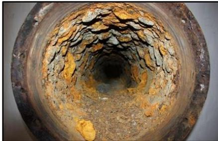
**Nota.** La figura muestra una tubería de transporte de curdo afectada por la aparición de microorganismos promotores de corrosión. Tomado de: "MIRC. ¿Qué es la corrosión microbiológica?," *Cleanstart*. [Online]. Available: <https://elektrokorrosion.com.ar/2020/04/07/mirc-que-es-la-corrosion-microbiologica/>
