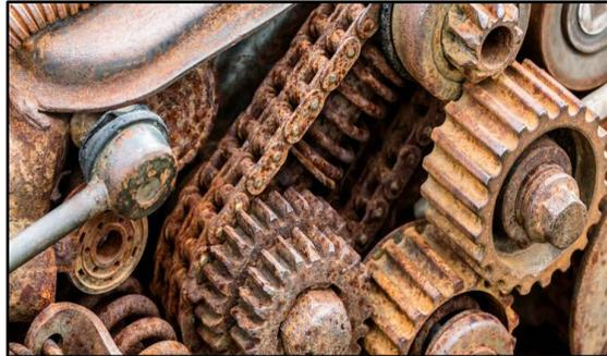
**Nota.** En la figura se puede observar el deterioro de una maquina debido al oxido que se produce por el contacto con el entorno. Tomado de: “¿Qué es la corrosión?,” Bardahl Industria, 24-Aug-2018. [Online]. Available: <https://www.bardahlindustria.com/explicacion-corrosion/>
