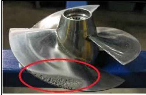
**Nota.** La figura muestra el proceso de corrosión por cavitación en una aleta, parecido a la corrosión por picadura con la diferencia de ser un daño mayor y más observable. Tomado de: CristianGar, “Corrosión por cavitación - ingeniería mecánica,” *corrosión por cavitación - ingeniería mecánica*, 27-Nov-2022. [Online]. Available:
