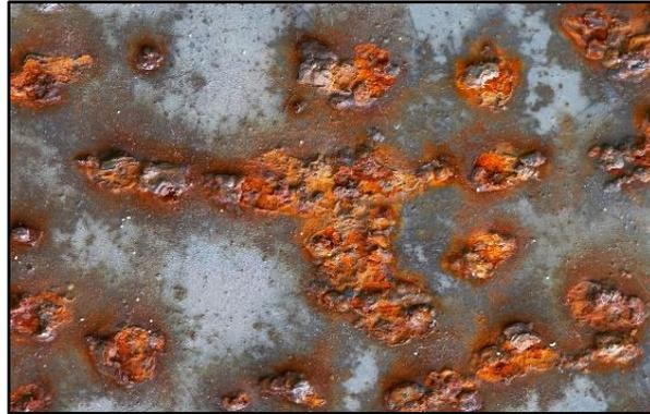
**Nota.** La figura muestra puntos de corrosión aleatorios en una superficie metálica. Tomado de: S. Parra, "Tipos de corrosión en el Acero," Tipos de corrosión en el acero. [Online]. Available: <https://blog.laminasyaceros.com/blog/tipos-de-corrosion-en-el-acero>
