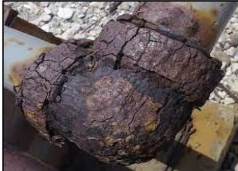
**Nota.** La figura muestra el proceso de corrosión erosiva en un codo de unión en tuberías. Tomado de: CristianGar, "Corrosión por erosión - Ingeniería mecánica," corrosión por erosión - ingeniería mecánica, 27-Nov-2022. [Online]. Available: <https://ingenieriamecanicacol.blogspot.com/2016/07/corrosion-por-erosion.html>
