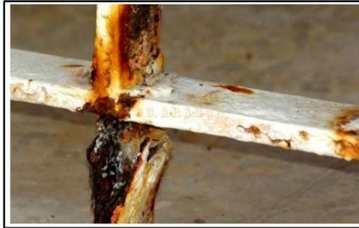
**Nota.** La figura muestra la afectación estructural por tensión en una pieza soldada. Tomada de: CristianGar, "Corrosión por esfuerzos - ingeniería mecánica," *corrosión por esfuerzos - ingeniería mecánica*, 27-Nov-2022. [Online]. Available: <https://ingenieriamecanicacol.blogspot.com/2016/06/corrosion-por-esfuerzos.html>
