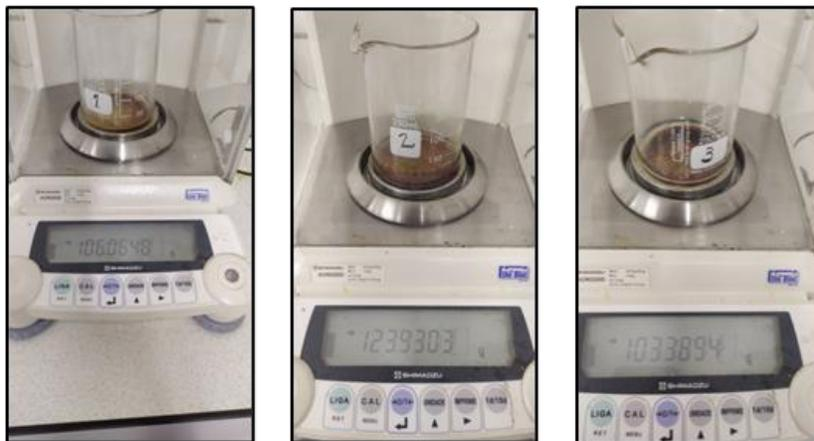
**Nota.** La figura muestra el peso de los beakers con el extracto seco en balanza analítica.
