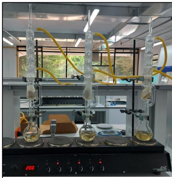
**Nota.** La figura muestra 3 montajes típicos soxhlet conectados en serie.
