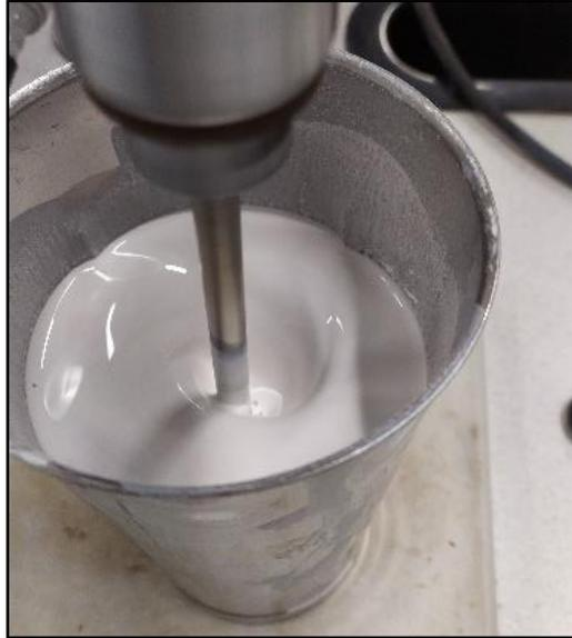
**Nota.** La figura muestra el aspecto de la pintura en el proceso de homogenización.
