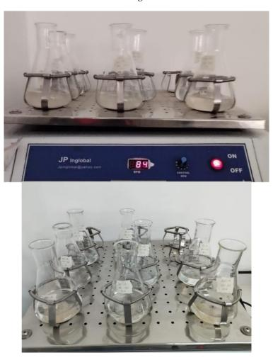
*Nota.* Se puede ver los beakers en el agitador a 84rpm y se dejaron durante 24 horas.
