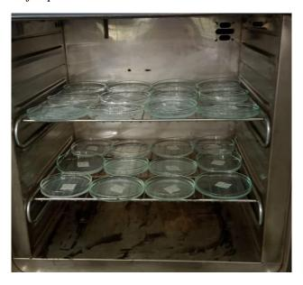
$\it Nota$ . En la foto se ven las cajas de Petri en el horno durante 48 horas a 40°C.
