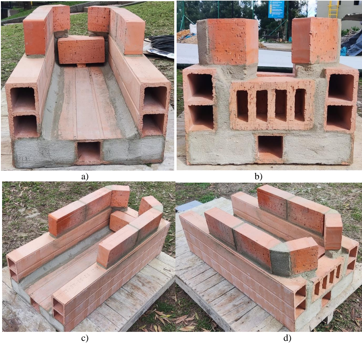
Figura 57. Estructura de Conservación del Calor – Hogar Construida
