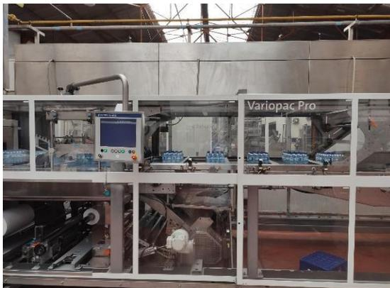
**Empaque:** El producto por medio de los transportadores se acumula para ingresar al proceso de empaque, tiene enfiladores para posicionar la botella a conveniencia de la máquina, a su vez por medio de unos separadores arrastra el paquete de producto que se va a empacar, por medio de unos rodillos que transporta el plástico, agrupando las botellas y finalmente metiéndolas al horno para finalizar el proceso.
