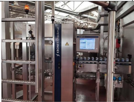
**Inspección:** En la primera etapa del proceso de inspección, el producto pasa por un inspector de alturas para comprobar el estado del envase, enseguida se transporta en medio de cámaras infrarrojas para detectar anomalías en la tapa, finalmente se transporta por sensores de llenado para verificar que se tenga el nivel de producto requerido por la empresa.
