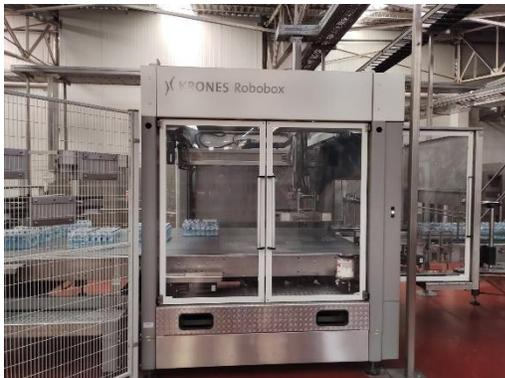
**Paletizado:** En el proceso de paletizado empieza en un equipo llamado ROBOBOX, este equipo está programado para posicionar los paquetes de producto y organizarlos de tal manera que puedan armar una fila de producto, enseguida se dirige a unas guías y un elevador para armar completamente el paletizado del producto, y por medio de la estiba se transporta para su almacenamiento.
