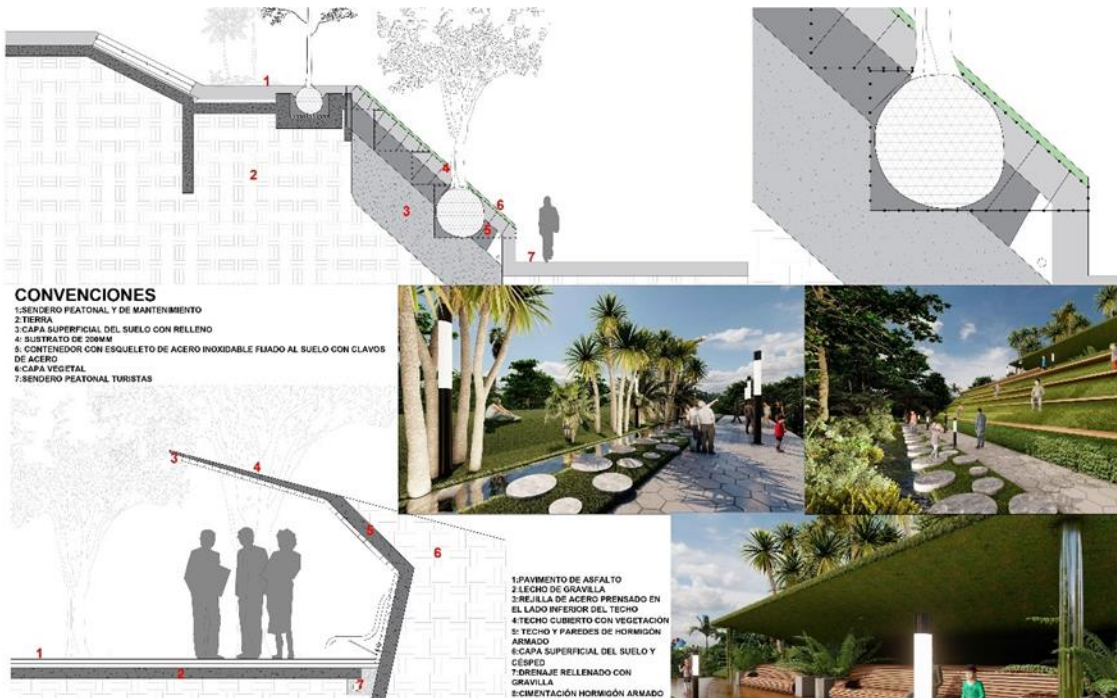
Nota. Detalles de taludes y cubiertas verdes.
