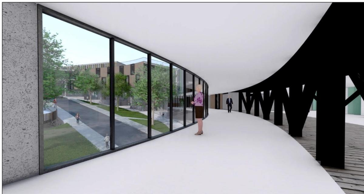
**Nota:** La figura muestra una vista interior del paso elevado al sur, que además deja ver como el sistema estructural de vigas vierendeel se integra al espacio y permite conectar el proyecto en los niveles superiores.
