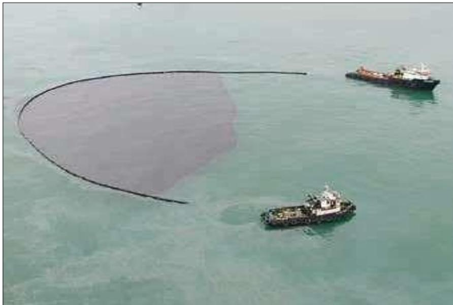
**Nota.** La imagen muestra una barrera inflable desplegada en una configuración en Entre dos embarcaciones para contener crudo pesado. Tomado de ITOPF, (2011a) p.5.
