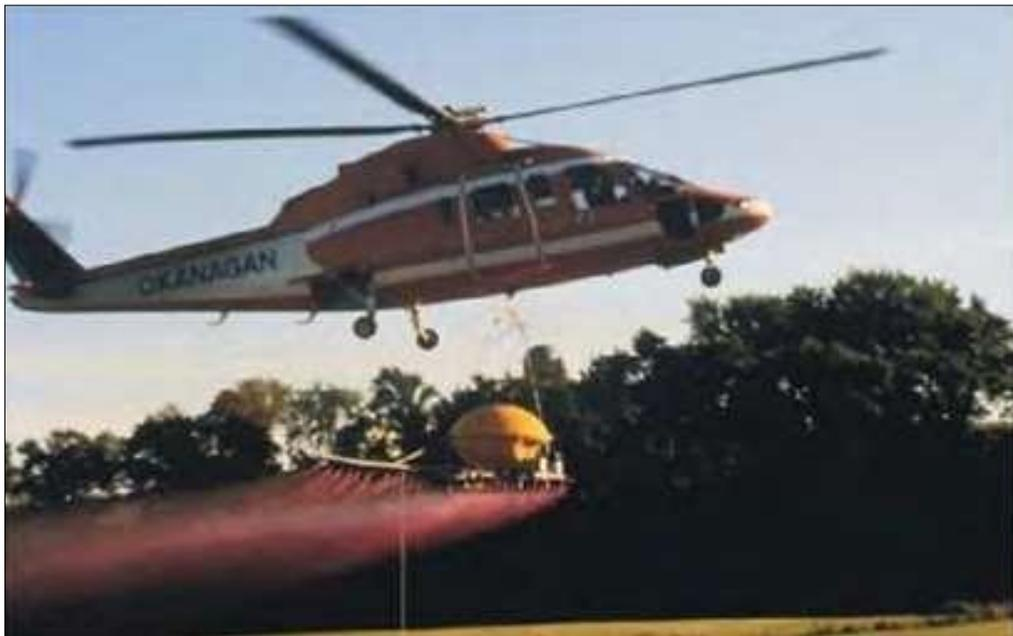
*Nota.* La imagen muestra el proceso de rociado de dispersante desde un helicóptero. Tomado de ARPEL, Guía para el uso de dispersantes en derrames de hidrocarburos. p.17.
