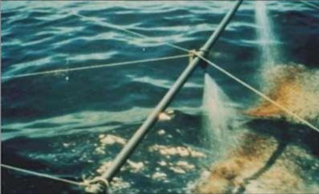
*Nota.* La imagen muestra el proceso de rociado de dispersante desde una embarcación. Tomado de ARPEL, Guía para el uso de dispersantes en derrames de hidrocarburos. p.17
