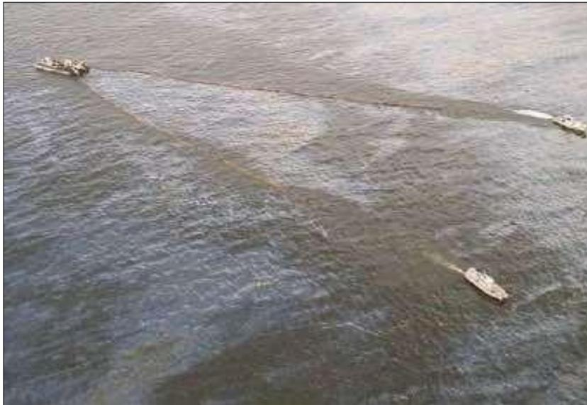
*Nota.* La imagen muestra el uso de una barrera de cortina con una configuración en V mediante dos remolcadores con una embarcación de recolección independiente en el vértice. Tomado de ITOPF, (2011a) p.7.
