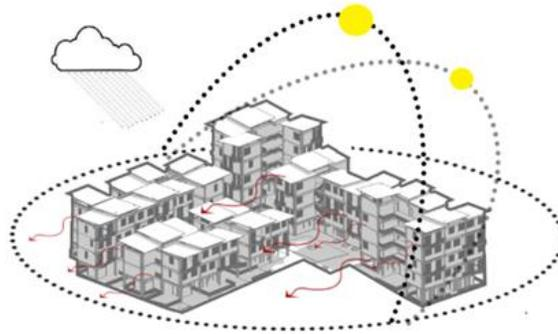
*Nota.* axonométrico bioclimático demostrando la incidencia solar en invierno a las 9:00am
