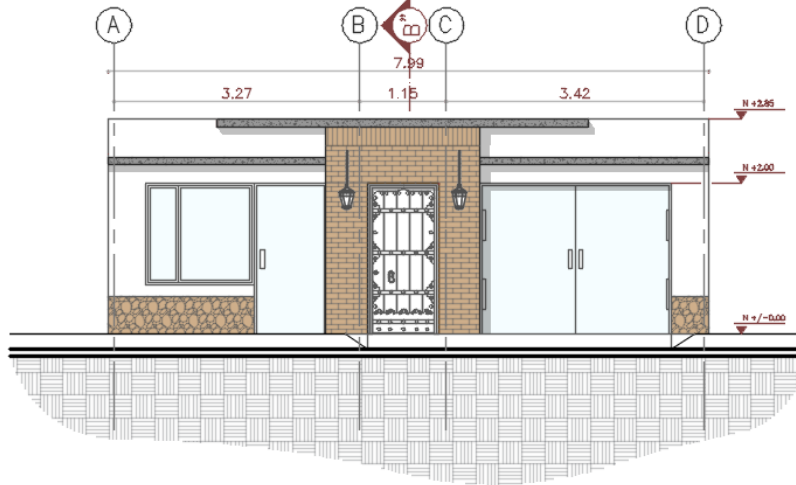
Fachada principal locales comerciales
