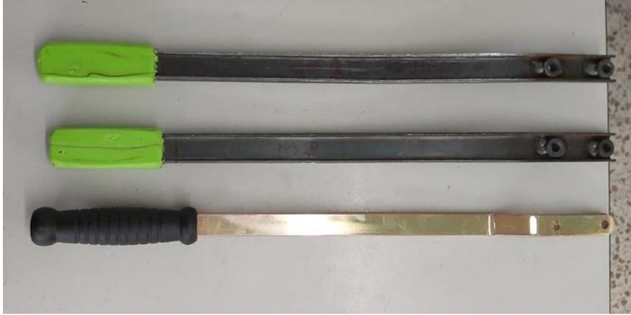
**Nota.** La figura evidencia palancas prototipadas para ciclado en banco de pruebas.
