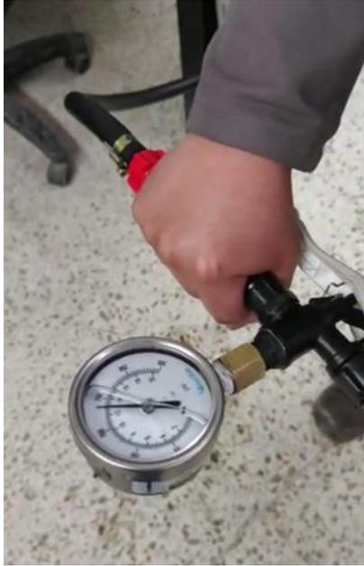
*Nota.* La imagen evidencia el bombeo de la palanca a una presión de 200 PSI.
