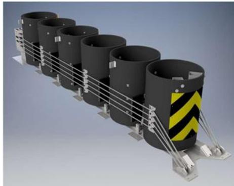
*Nota.* La Figura muestra los cilindros de HDPE interconectados por cables de acero. Este conjunto está fijado a la superficie mediante soportes fijos a los extremos de los cables de acero. Tomado de: Valtir, "REACT® M". Disponible: <https://www.valtir.com/product/react-m/>
