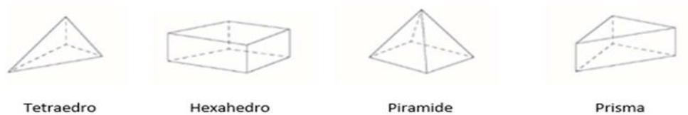
*Nota.* Figuras utilizadas para el enmallado de los elementos a simular en el módulo Explicit Dynamics. Tomado de: Universitat Politècnica De València, “Diseño De Un Elemento De Protección De Espalda Para Motociclistas”. Disponible: <https://riunet.upv.es/bitstream/handle/10251/76178/Tesis.pdf?sequence=1&isAllowed=y>
