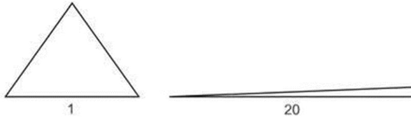
**Nota.** En la Figura se observa un triángulo con una proporción de 1 y a su lado un triángulo con una proporción de 20. Fuente: <https://featips.com/2022/11/21/ansys-mesh-metrics-explained/>
