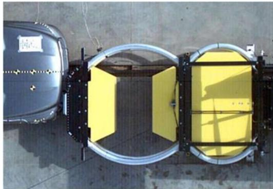
*Nota.* En la Figura se observa el dispositivo "Scorpion II", el cual se compone de dos óvalos en acero, los cuales dispersan la energía del impacto. Tomado de: traffix devices, “Manual for Assessing Safety Hardware”. Disponible: <https://www.traffixdevices.com/products/attenuators/scorpion2-tma>
